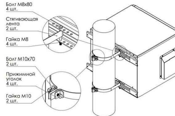
**ВНИМАНИЕ!** Во избежание падения изделия, шкаф следует устанавливать только на бетонные или кирпичные стены, а так же столбы!
